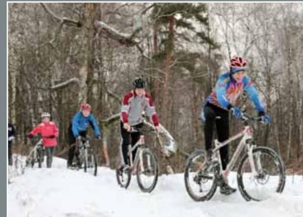
должен оставаться в строго вертикальном положении. При попытке наклонить его в сторону поворота, как летом, вы и глазом моргнуть не успеете, как растянетесь на дороге. Основное количество шипов находится по центру покрышки. При наклоне велосипеда сцепление резко ухудшается, так как его обеспечивают уже не 3–4–6 рядов шипов, а максимум один. Как только и он теряет контакт, вы
