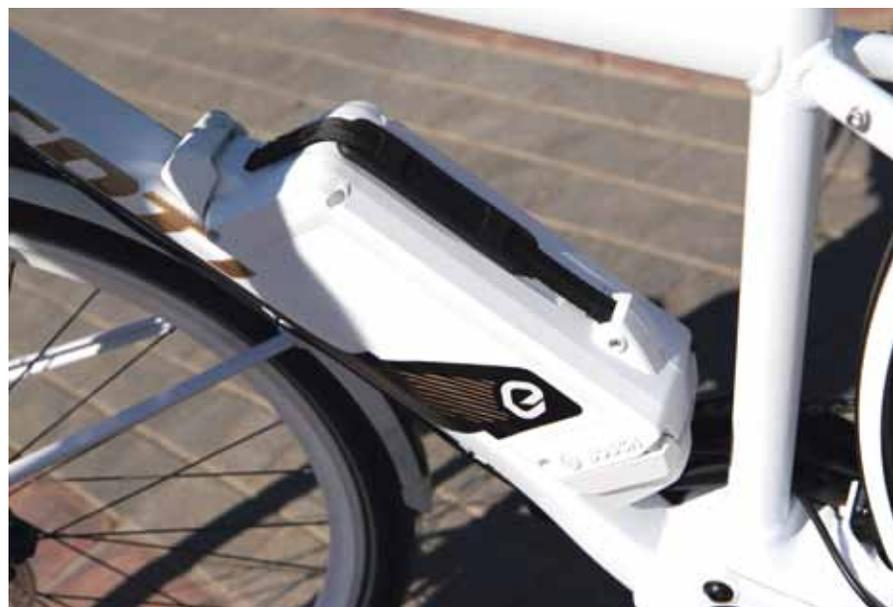
⤵ Батарея снимается при помощи ключа, похожего на ключ от почтового ящика, и устанавливается буквально за секунды
