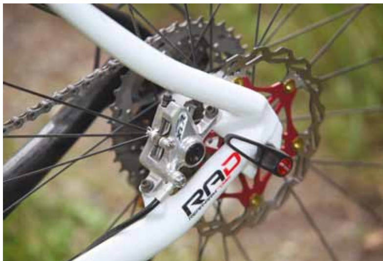
▲ Крепление калипера на нижнем пере
